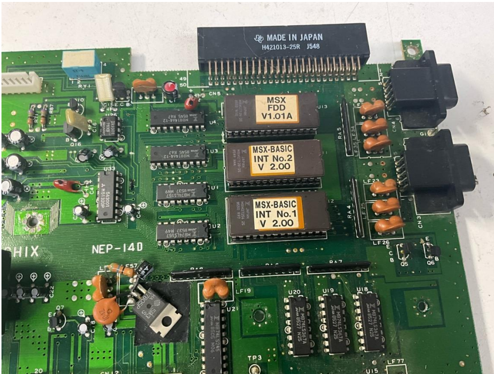
De originele disk-ROM, U13, in de IC-voet.
