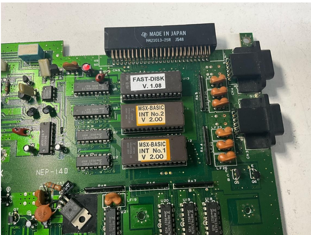
De nieuwe disk-ROM is geplaatst in de IC-voet van U13.
